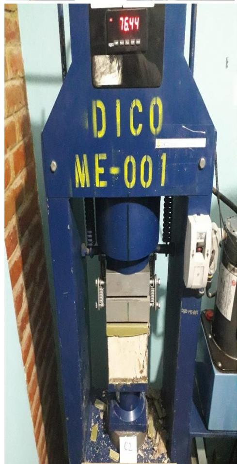
**Resistencia a la Flexión del Concreto Usando Viga Simple NMX-C-191-ONNCCE-Vigente**
